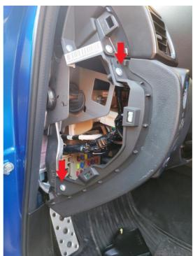
Demontiere nun die Verkleidung unter dem Lenkrad, diese ist nun nur noch durch Clips befestigt, ziehe die Verkleidung vorsichtig ab. Bevor du sie komplett abnimmst, löse noch die Stecker.
