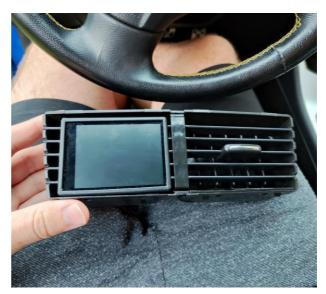
Nun kannst du, bevor du alles wieder in umgekehrter Reihenfolge zusammenbaust, kurz die Zündung einschalten und das Display auf Funktion prüfen. Ist diese gegeben kannst du das Fahrzeug komplettieren und bist fertig.
