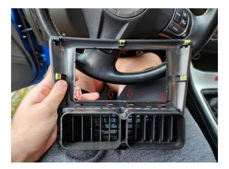
Nun müssen noch die Lamellen aus der Lüftung entfernt werden. Dazu müssen die vorderen Lamellen auf der entsprechenden Seite etwas nach oben aus Ihrer Verankerung gezogen werden. Anschließend können diese entnommen werden.
