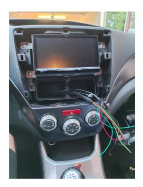
Danach kann die Luftzufuhr wieder verschraubt werden und die Anzeige angesteckt und montiert werden.
