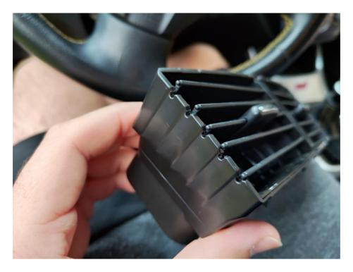
Danach sind die hinteren Lamellen dran, gehe dazu mit deinem Fingernagel zwischen die beiden Kunststoffkanten und drücke dabei von hinten gegen die Lamellen.
